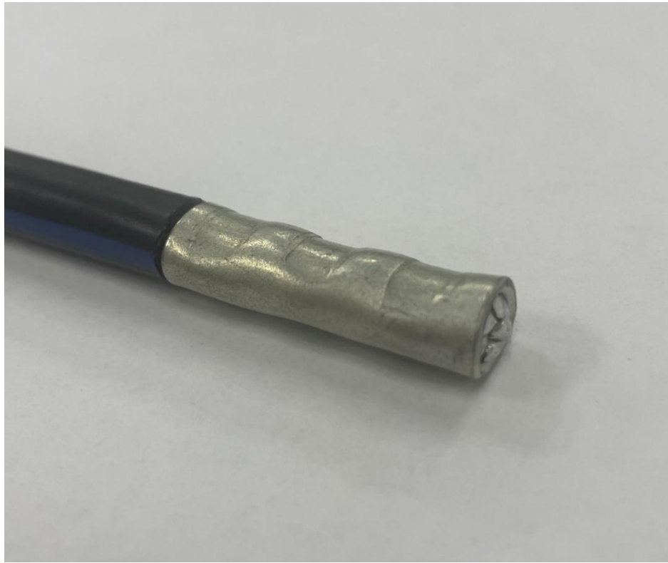
Рисунок 15 - Пример обжатия многожильного провода
